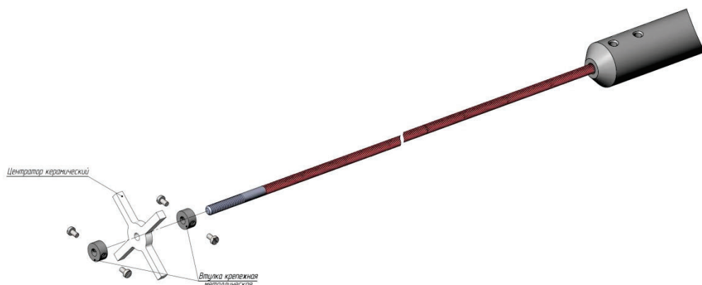
Рисунок Е121 – Монтаж керамических центрирующих дисков к одиночному гибкому зонду при помощи нержавеющей втулок для температуры до 500°C
