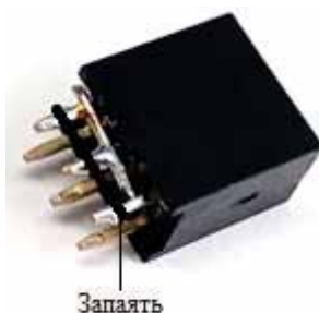
Рисунок 50 – Разъем PBD-6 с соединенными между собой тремя контактами с одной стороны
