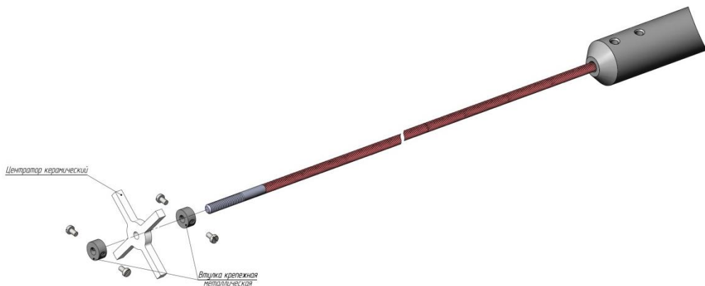
Рисунок E121 – Монтаж керамических центрирующих дисков к одиночному гибкому зонду при помощи нержавеющей втулок для температуры до 500 °С
