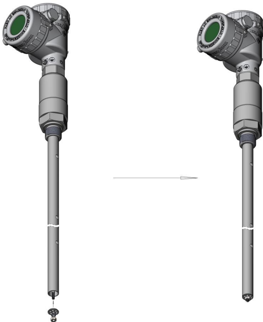
Рисунок М1.6 – Установка заглушки коаксиального зонда
