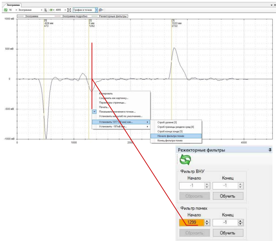
Рисунок 32. Установка начала фильтра помех
