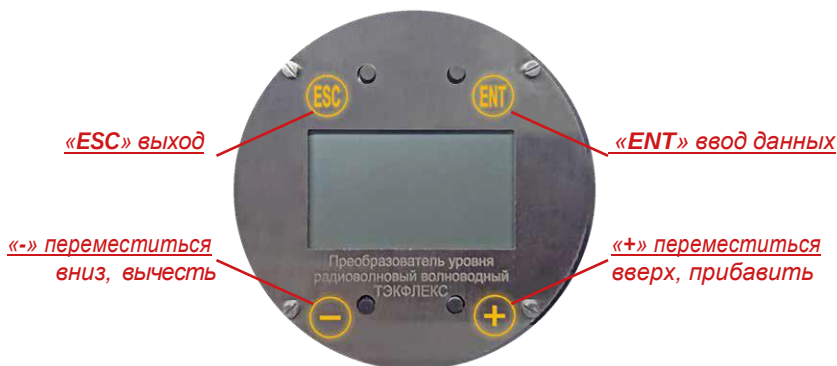
Рисунок 62. Органы управления блока индикации
