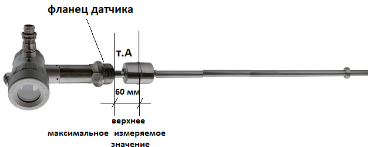
Рисунок 20 - Верхнее положение поплавка
