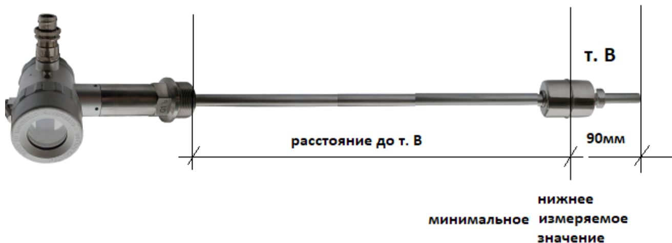
Рисунок 26 - Нижнее положение поплавка
