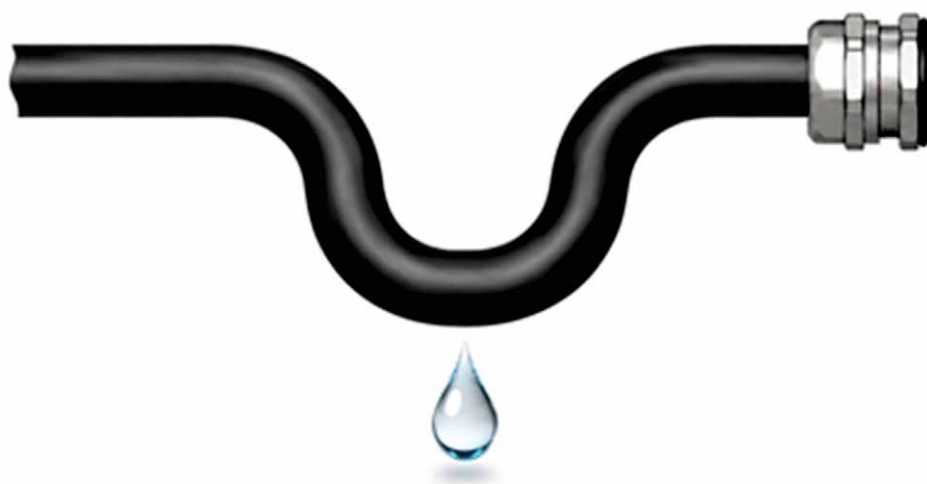
Рисунок 21 – Присоединение кабеля к прибору
