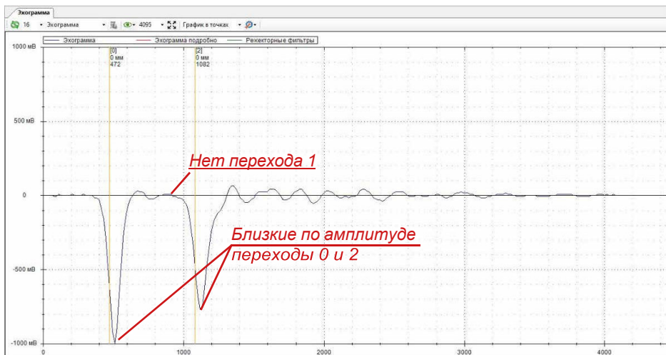
Рисунок 17. Эхограмма при отключенном чувствительном элементе
