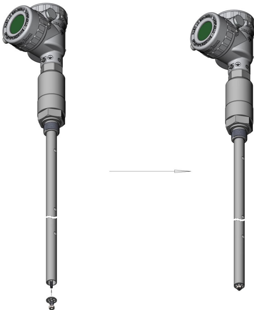
Рисунок М1.6 – Установка заглушки коаксиального зонда
