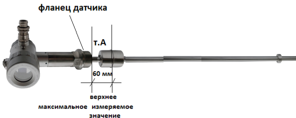
Рисунок 20 - Верхнее положение поплавка
