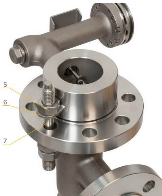
Рисунок 10 – Установка преобразователя на соединительный фланец
