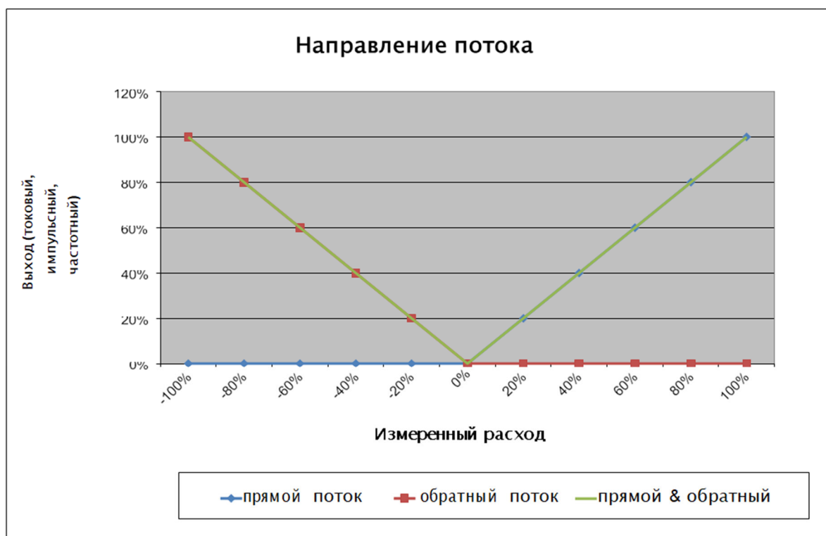
Рисунок 40 - Влияние настройки направления потока
