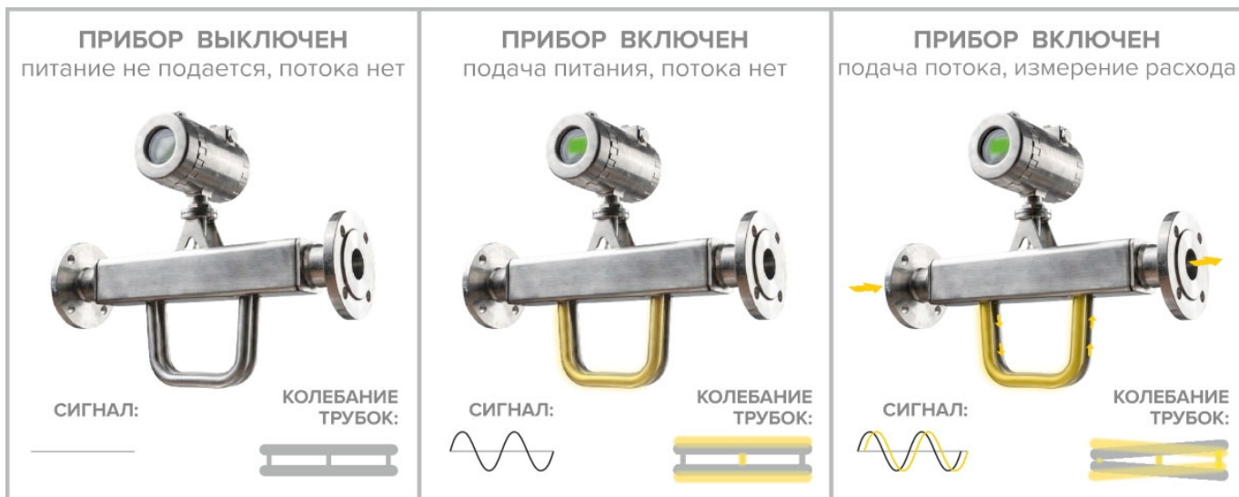
Рисунок 1 – Силы, действующие на расходомер
