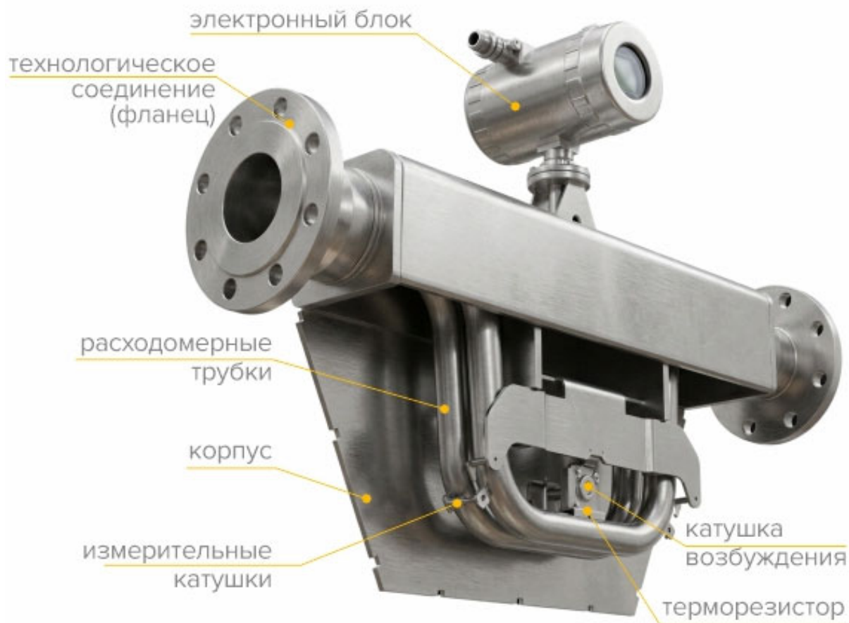
Рисунок 3 – Устройство расходомера
