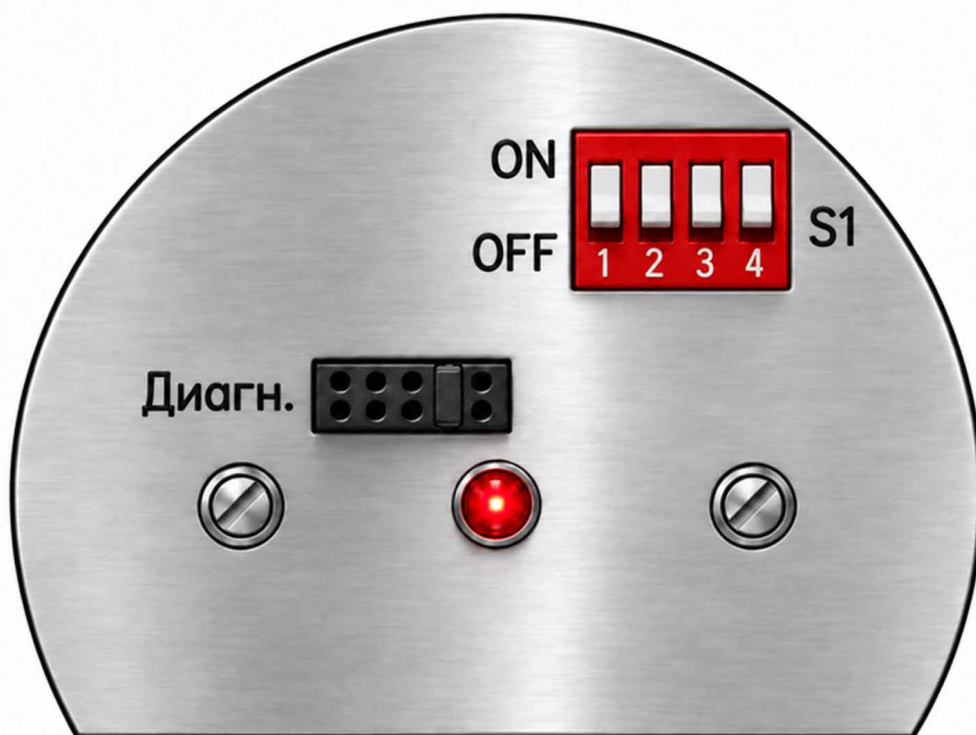
Рисунок 44 – Положение перемычки при переключении сигнализаторов в режим «Диагностика»
