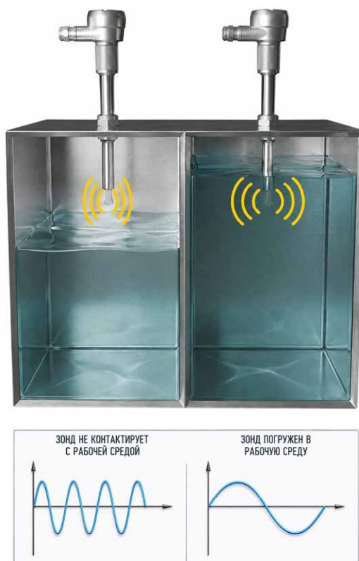
Рисунок 4 – Принцип действия
