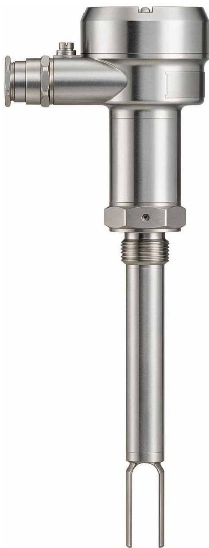
Сигнализатор уровня сыпучих продуктов с размером гранул до 5 мм и плотностью не менее 800 кг/м 3 с вилочным сенсором ВИБРОТЭК-УС-М-В
