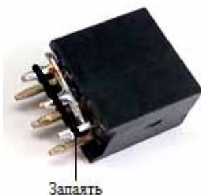
Рисунок 46 – Разъем PBD-6 с соединенными между собой тремя контактами с одной стороны
