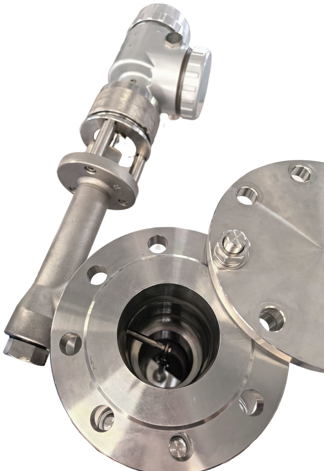
Рисунок 12 – Установка цепи буйка
