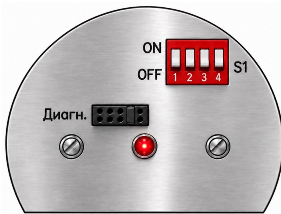
Рисунок 43 – Положение переключки при переключении сигнализаторов в режим «Диагностика»
