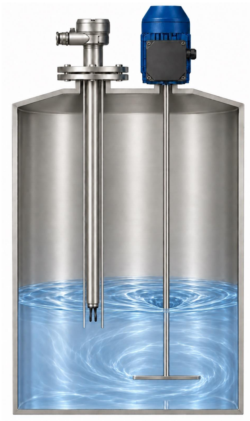
Рисунок 58 – Установка сигнализатора в успокоительной трубе
