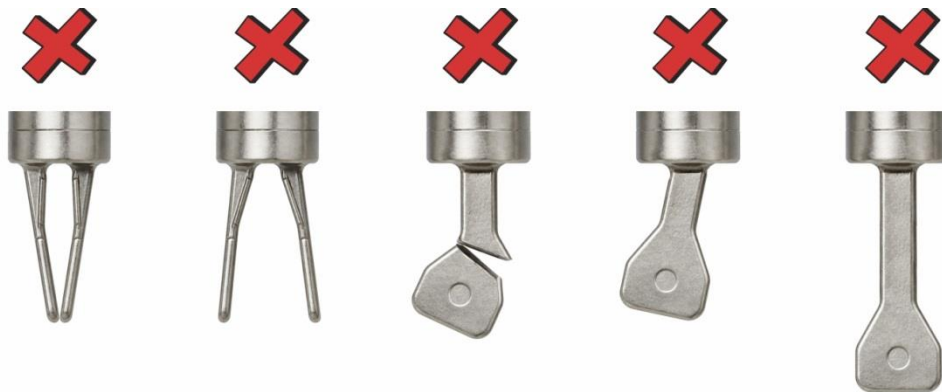
Рисунок 53 – Не деформировать вилку сигнализатора
