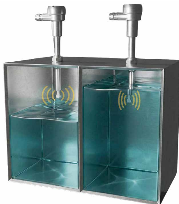
ЗОНД НЕ КОНТАКТИРУЕТ С РАБОЧЕЙ СРЕДОЙ
