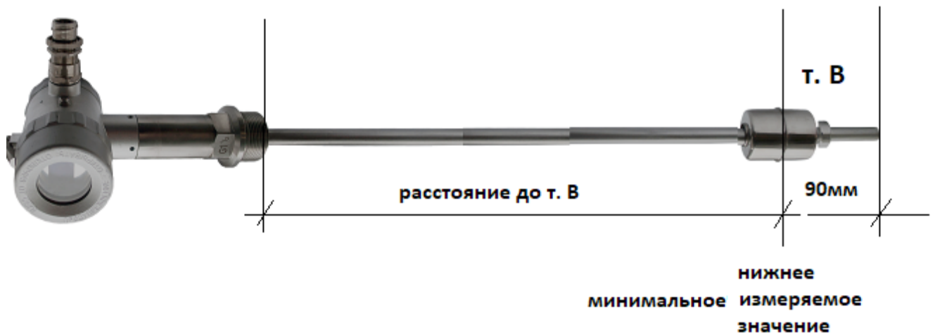
Рисунок 26 - Нижнее положение поплавка
