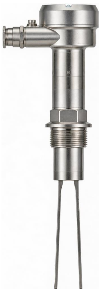
Сигнализатор уровня сыпучих продуктов без ограничений по размеру и форме гранул/сырья и плотностью от 50 кг/м 3 с широкой вилкой ВИБРОТЭК-УС-М-В
