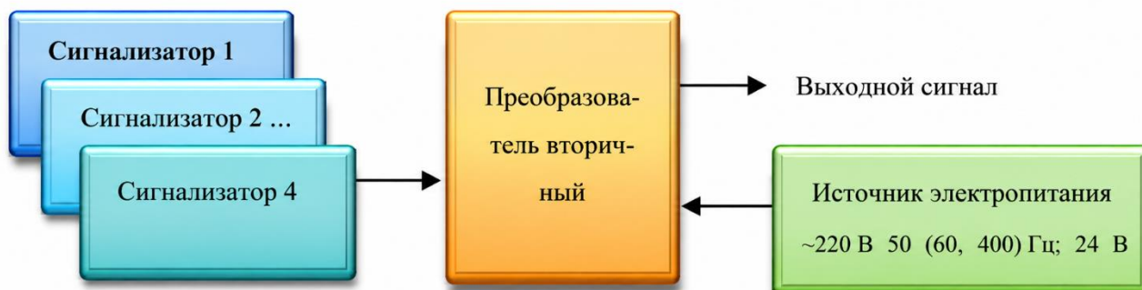
Рисунок 4 – Структурная схема сигнализаторов с вторичным преобразователем
