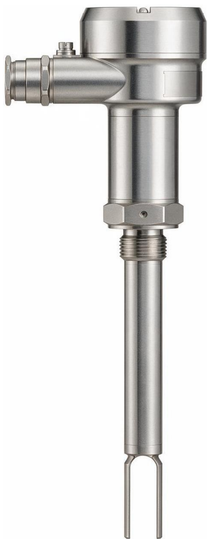
Сигнализатор уровня сыпучих продуктов с размером гранул до 7 мм и плотностью не менее 800 кг/м 3 с вилочным сенсором ВИБРОТЭК-УС-М-В
