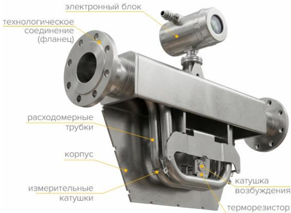
Рисунок 3 – Устройство расходомера
