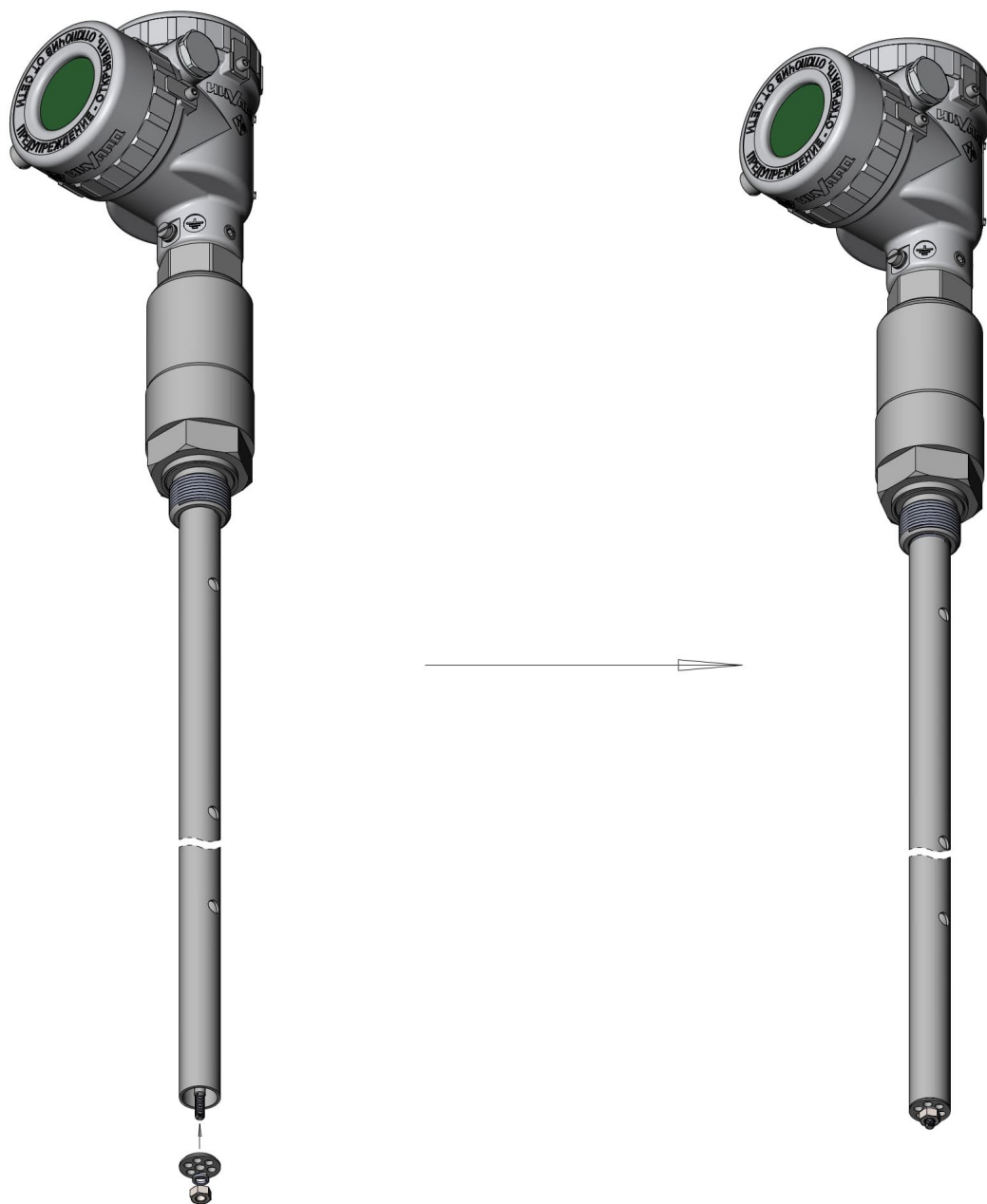
Рисунок 20 – Установка заглушки коаксиального зонда
