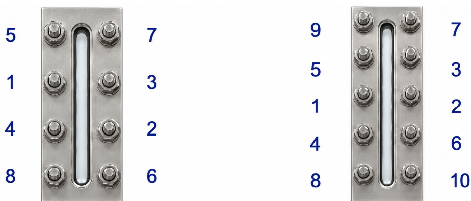
Рисунок 8 - Примерный порядок затяжки шпилек
